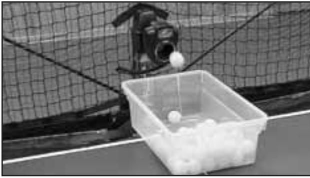
Coloque el cubo de plástico debajo del tirador. Luego mantenga el Botón de OK/Menu oprimido hasta que la pantalla se vuelva en blanco y luego suéltelo. Después de que la pantalla se vuelva completamente negra, oprima el Botón de Abajo (↓). Aparecerá el siguiente mensaje:
