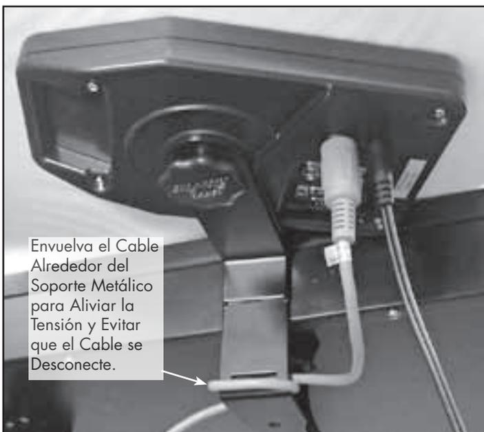
Envuelva el Cable Alrededor del Soporte Metálico para Aliviar la Tensión y Evitar que el Cable se Desconecte.
