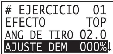
**AJUSTE DEM** (ajuste de demora) se utiliza para incrementar o reducir el tiempo de demora entre cada tiro. El valor puede cambiarse desde -100% hasta +900% por incrementos del 10%. En vista de que la DEMORA se ajusta según un porcentaje, hasta los ejercicios que tienen programados otros valores de DEMORA empezarán a funcionar correctamente. Los jugadores de muchos niveles distintos pueden utilizar el mismo Ejercicio sin necesidad de volver a escribirlo.
